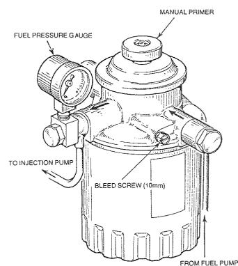
FUEL PRESSURE GAUGE AND FUEL FILTER
